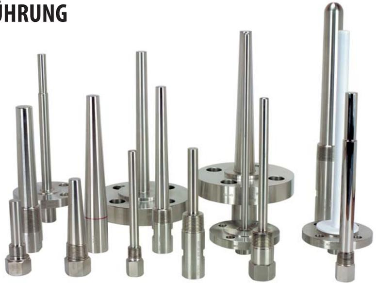
Schutzhülsen schützen Thermometerfühler vor Korrosion und vor Drücken und Fließgeschwindigkeiten. Sie ermöglichen einen Ausbau des Thermometers (z.B. Auswechslung oder zur Kalibrierung) ohne den Prozesskreislauf zu beeinflussen bzw. zu unterbrechen.
